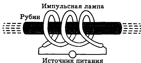
Рис. 10.9. Конструкция лазера Меймана
