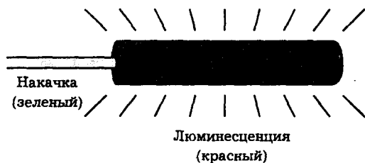
Рис. 10.10. Наблюдение люминесценции кристалла рубина в луче аргонного лазера
