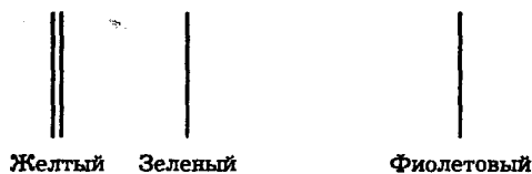
Рис. 16.11. Спектр излучения ртутной лампы, полученный с помощью отражательной дифракционной решетки
