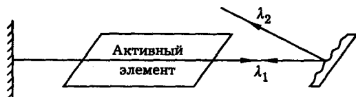
Рис. 16.12. Схема применения отражательной дифракционной решетки в лазере на красителе
