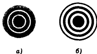
Рис. 11.14. Вид интерференционной картины “кольца Ньютона”, наблюдаемой при освещении белым (а) и окрашенным (б) светом
