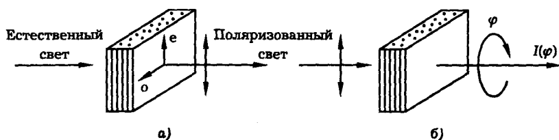
Рис. 21.18. Анизотропное поглощение. Получение (а) и анализ (б) поляризованного света с помощью кристалла турмалина
