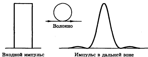
Рис. 19.15. Пример трансформации светового импульса в оптическом волокне
