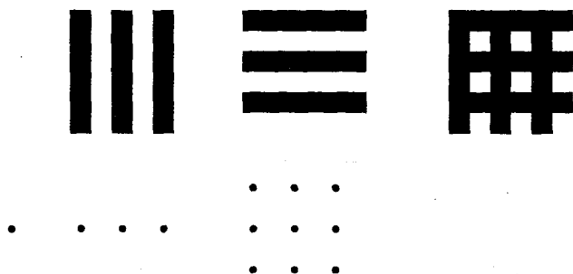
Рис. 16.17. Построение двумерной периодической структуры путем наложения скрещенных решеток и качественный вид дифракционных картин после первой и второй решеток при освещении системы лазерным пучком
